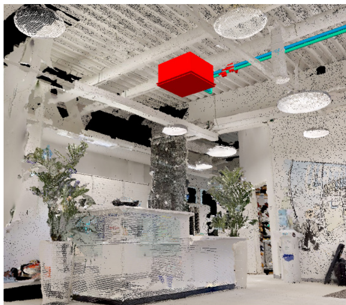
Pistepilvimalli yhdistetty MagiCadilla tuotettuun LVI-tietomalliin.
